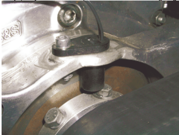
Exempel på cylinder puls givaren på vevaxeln, med 8 kuggar.
